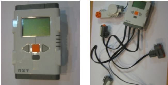
Abb. 3: Links: der Lego Mindstorm NXT®-Prozessor hat eine Anzeige, um folgendes zu visualisieren: eine Reihe von Menüs für eingebaute Testprogramme, von den Kindern erstellte Programme, Bluetooth-Nachrichten, etc. Die Pfeile können verwendet werden, um die Menüs zu scrollen, die orange Taste für das Programm, die graue Taste, um zurück in das Menü zu gelangen oder zum Ausschalten des Roboters. Rechts: Sensoren und Motoren, die mit dem Prozessor verbunden sind.
