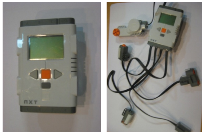
Abb.9 Links: Der Lego Mindstorm NXT® Prozessor Baustein, der ein Display mit mehreren Übungsprogrammen enthält. Mit den Pfeiltasten können die Menüs durchsucht werden, und mit dem orangenen Knopf wird eine Porgamm gestartet. Mit dem grauen Knopf darunter kommt man einen Schritt zurück oder schaltet den Roboter ab. Rechts: Mit dem Prozessor verbundene Sensoren and Motoren.
